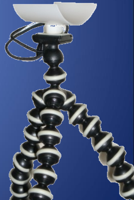
Τρίποδο με αυτοσχέδια βάση στήριξης wiimote
